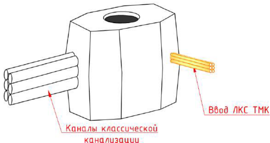
Рисунок 29 – Стыковка классических кабельных каналов и ЛКС ТМК
