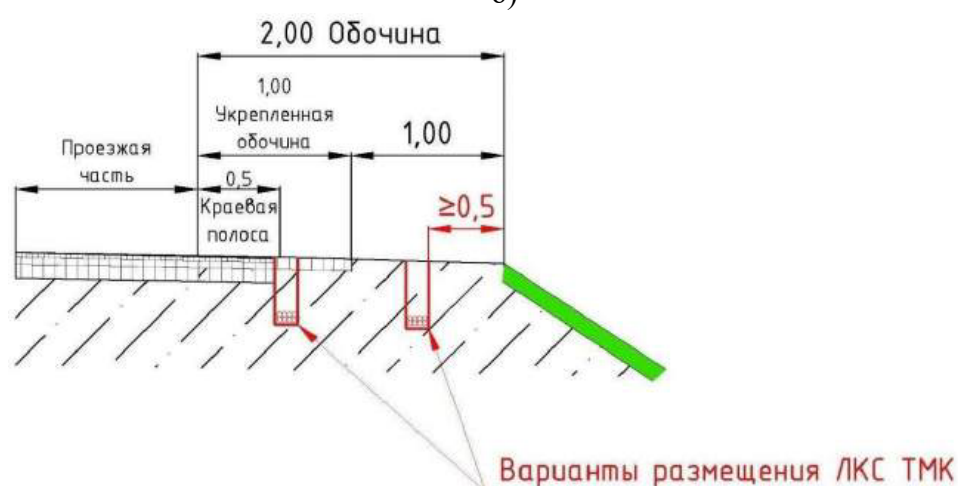
Рисунок 10 – Типовые варианты размещения мини-траншеи для прокладки ЛКС ТМК в обочине эксплуатируемых автомобильных дорог: а) для автомобильных дорог категории IА, IБ, IВ; б) для автомобильных дорог категории II; в) для автомобильных дорог категории III; г) для автомобильных дорог категории IV
