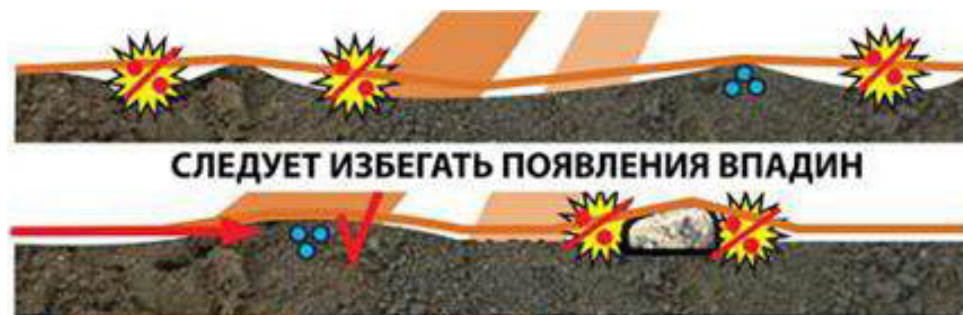
Рисунок 9 – Причины, усложняющие пневматическую задувку кабеля
