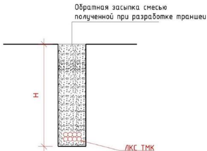
Рисунок 12 – Пример типового восстановления мини-траншеи в неукрепленной части обочины
