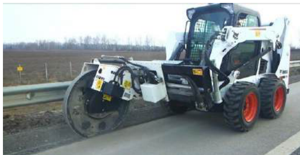
Рисунок 11 – Вибротрамбовочная техника на базе мини-погрузчика
