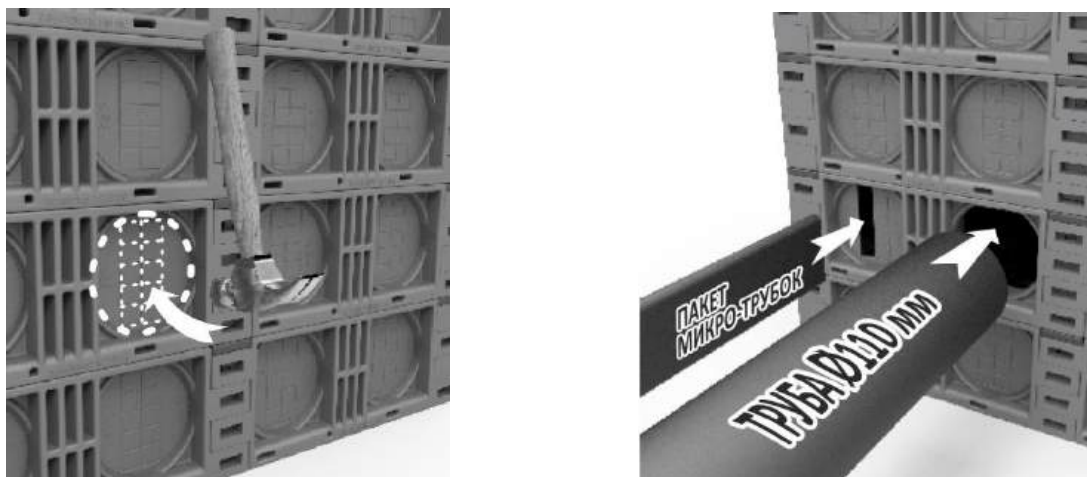
Рисунок 44 – Подготовка отверстий в смотровом устройстве и ввод кабельных каналов
