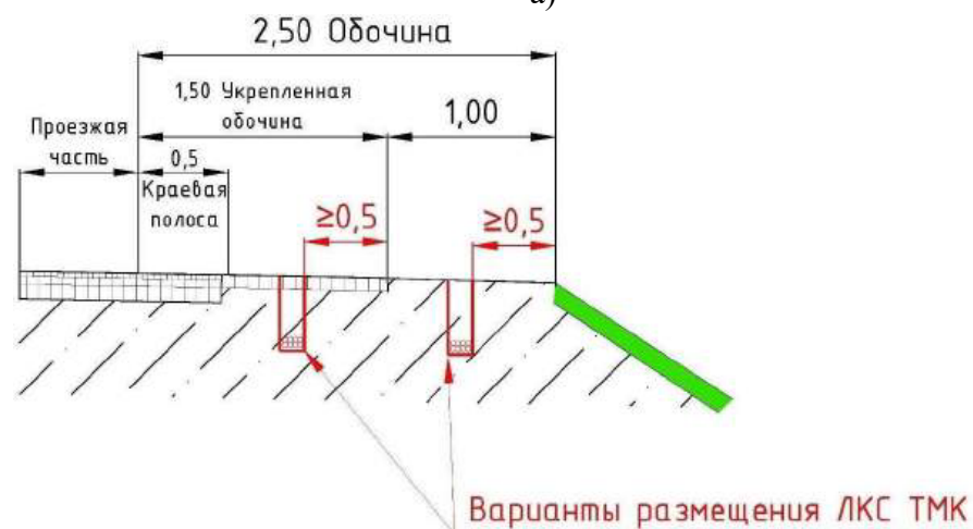
Рисунок 10 – Типовые варианты размещения мини-траншеи для прокладки ЛКС ТМК в обочине эксплуатируемых автомобильных дорог: а) для автомобильных дорог категории IА, IБ, IВ; б) для автомобильных дорог категории II; в) для автомобильных дорог категории III; г) для автомобильных дорог категории IV
